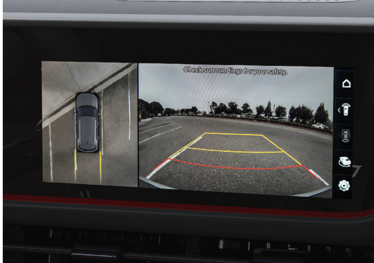
شاشة الرؤية المحيطة (SVM) توفر شاشة الرؤية المحيطة (SVM) رؤية بانورامية بزاوية 360 درجة للسيارة ومحيطها. يُعد هذا النظام الاختياري مفيدًا للغاية عند محاولة ركن السيارة في موقف ضيق.
